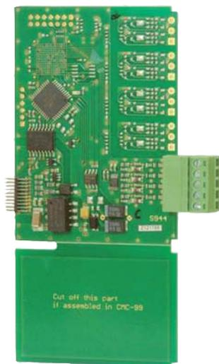
Les modules FI2 & FI4 sont spécialement dédiés aux applications de mesure de débit. Ces cartes permettent la lecture, l'acquisition et l'enregistrement des débits instantanés ainsi que de la totalisation que délivrent les sorties analogiques des capteurs dédiés à ces applications.
