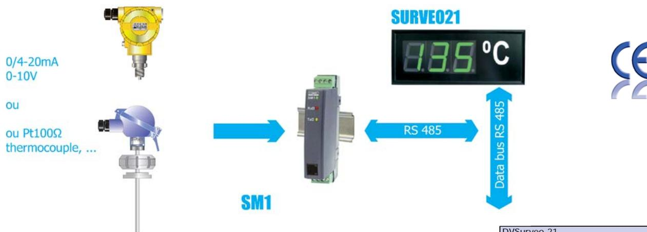
Mesure et visualisation du signal température d'une Pt1000
