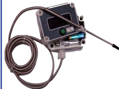
Le LET11 est un thermomètre numérique à LED, alimenté par pile. Constitué d'une sonde PT1000Ω et d'un indicateur indépendant, il permet de disposer d'une mesure de température de grande précision là où il n'est pas envisageable de disposer d'une alimentation électrique. Un bouton poussoir permet de déclencher la lecture afin d'économiser l'énergie des piles nécessaires au fonctionnement du thermomètre.
