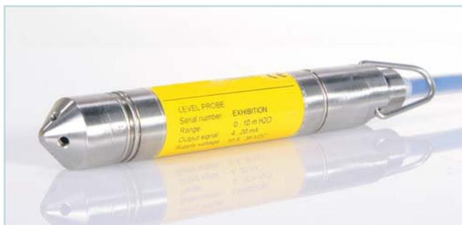
Les capteurs de niveau SLSH25 sont destinés à la mesure du niveau de liquides propres dans les réservoirs, les puits de forage, les citernes. Le principe de mesure est basé sur la relation existante entre la hauteur de la colonne de liquide et la pression hydrostatique. Il restitue la mesure sous la forme d'un signal analogique standard.
