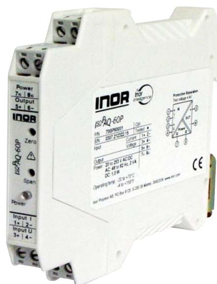
Le transmetteur isolateur IsoPAQ-60P est utilisé pour l'isolation et la conversion avec une grande précision des signaux unipolaires et bipolaires 0(4)-20 mA et 0-10 V.
