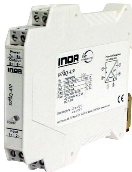
Le transmetteur-isolateur IsoPAQ-41P est utilisé pour l'isolation et la conversion de signaux 0-20 mA, 4-20 mA et 0-10 V unipolaires nécessitant une haute précision.
