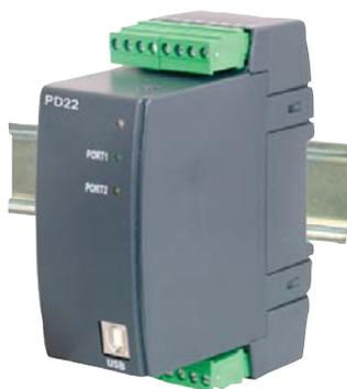
Le transmetteur «network» PD22 permet le stockage de données afin d'accélérer et de fluidifier les transferts d'informations entre les instruments de mesure et le système de traitement ou d'exploitation. Il dispose en standard des interfaces RS-232, RS-485 et USB. Il permet de stocker 390000 points de mesure ainsi que 44000 évènements.
