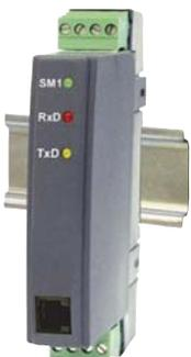
Modules de conversion de signaux analogiques, courant, tension, résistance et Pt100Ω. Deux (SM1) ou quatre (SM2) voies indépendantes en entrée. Sorties digitales RS-485 et RS-232 MODBUS en mode RTU et ASCII. Sorties isolées galvaniquement. Fonctions mathématiques entre voies. Courbe de linéarisation. Stockage des min/max.
