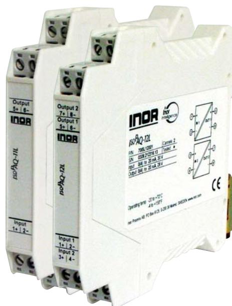
Les IsoPAQ-11L et IsoPAQ-12L sont des isolations galvaniques 1 et 2 voies pour signaux 0(4)-20 mA. Leur utilisation permet de supprimer toutes erreurs de mesure liées à des différences de potentiel ou résultant de points communs sur l'alimentation des boucles de régulation.
