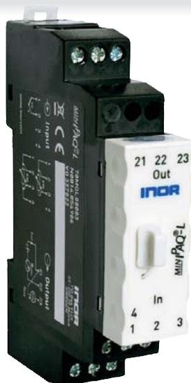
Le MINIPAQ-HLP est un transmetteur numérique standard non isolé et multi-capteurs. Très facile d'utilisation, il se configure au moyen du logiciel ConSoft sous windows® via un simple port USB, cette opération ne réclame que quelques secondes. Aucune alimentation externe n'est nécessaire pour effectuer cette opération.
