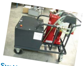
Système de filtration mobile.
